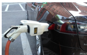
设备连接在充电机与电动汽车之间
