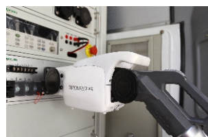
设备连接在充电机与电动汽车模拟器之间
