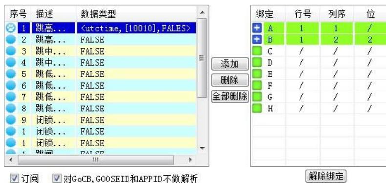
例: 将左上图数据集中数据序号为 1 的结构体类型数据中的“[10010]”中从右数的第二个“1”绑定在了开入量 B 上, 我们可以看到右上图开入量框中, 开入量 B 的行号为 1, 与数据集数据集中的数据序号一致, “列序”为“2”对应着结构体数据中从左数第二个数据“[10010]”, “位”为“2”对应着此字符串中从右数第二位“1”所在的位数。
