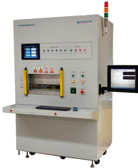
大功率半导体IGBT测试平台测试现场
